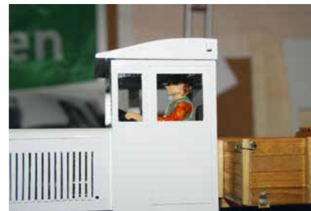
Endlich sind die Scheiben eingesetzt. Oben am Dach gut zu erkennen: die Winker
