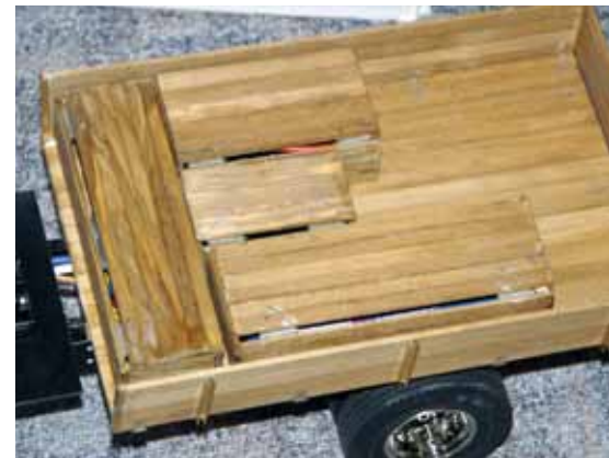
Vier Kisten verstecken Akku, Empfänger, M20 und die Kabelage
