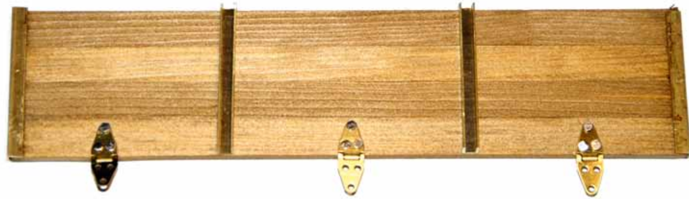
Die Heck- und beide Seitenklappen erhielten noch Scharniere, damit sie beweglich sind
