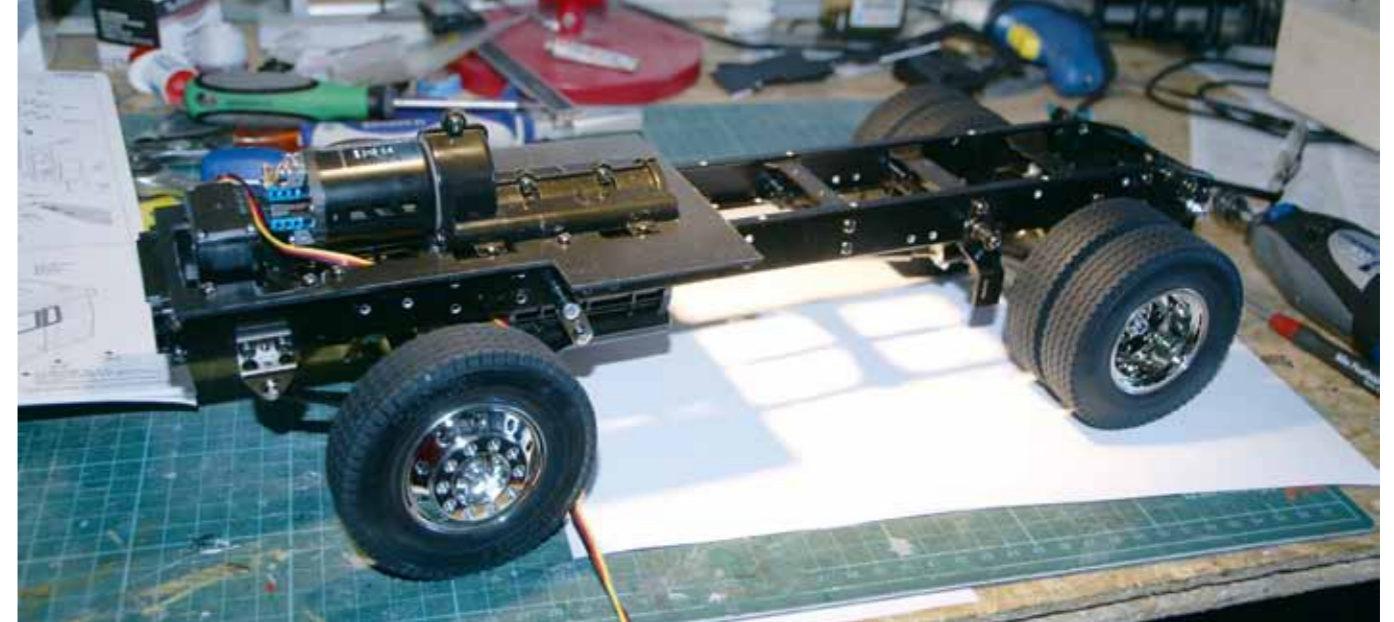
Für den Unterwagen wurden Rahmen, Getriebe, Motor und Lenkservo vom Tamiya-MAN behalten, da es zeitgenössisch zum Fageol passte
