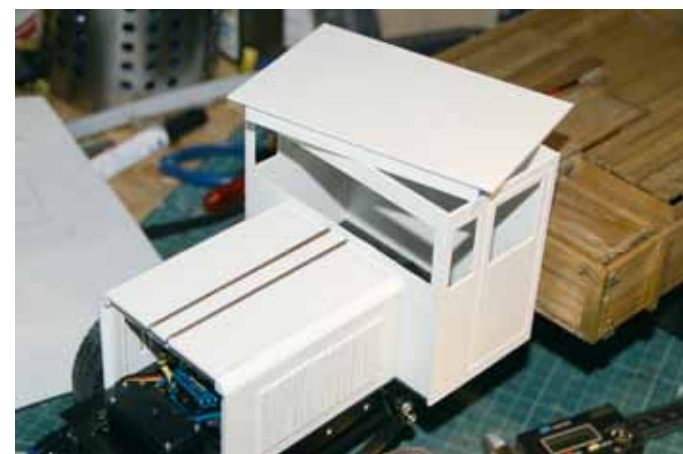
Das Grundgerüst des Dachs: darüber kommt noch ein leicht abgerundetes Stück Polystyrol um die „Schiebermützen“-Optik zu schaffen
